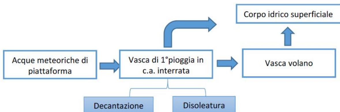
La seconda tipologia è rappresentata da vasche in c.a. interrate, nelle quali viene effettuato il trattamento delle acque di prima pioggia in arrivo al presidio, utilizzando apparecchiature idrauliche quali pompe di sollevamento, paratoie meccaniche e misuratori di livello ad ultrasuoni. A questa tipologia di vasche sono affiancate vasche volano dalle quali l'acqua viene rilanciata ad un corpo idrico.
